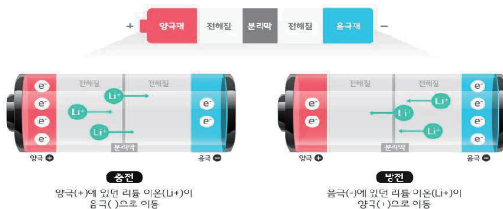
|| 그림 65 || 리튬이온배터리 구조와 작동 원리
