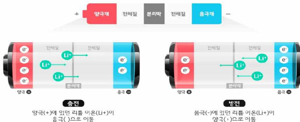
|| 그림 1 || 리튬이온배터리 구조와 작동 원리
